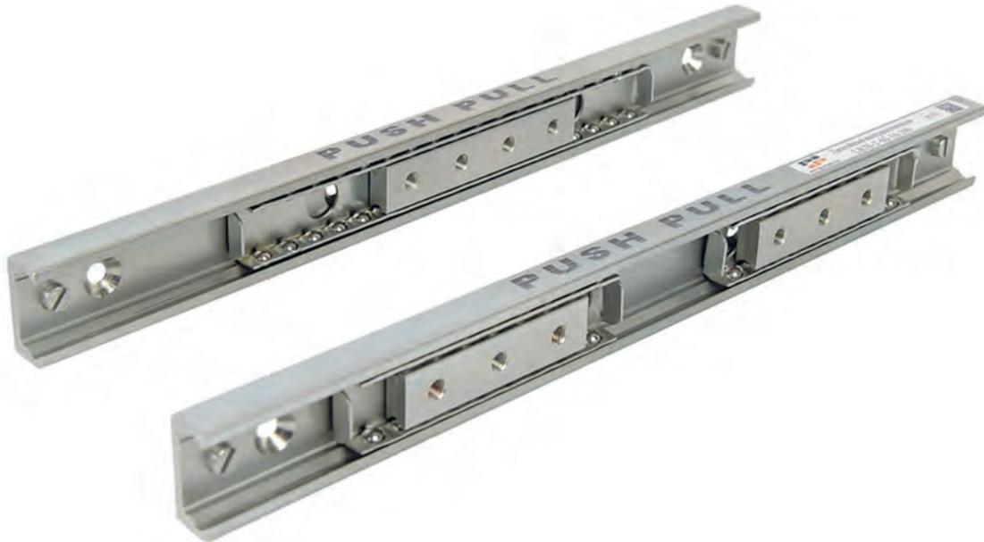
Стальной холодноотянутый С-образный профиль. Система включает в себя профильную линейную направляющую с сечением С-образной формы с одной и более каретками, перемещающиеся во внутреннем пространстве направляющей и оснащенных сепаратором с шариками. Это самая грузоподъемная серия линейных направляющих PUSH PULL.
